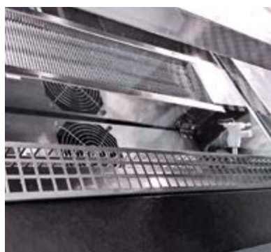
výklopné ventilátory pro lepší sanitaci
