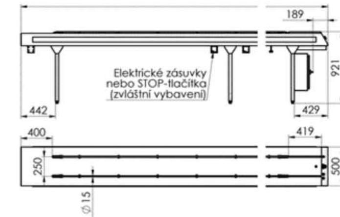
**DP1 Tabletovací dopravník pásový**
